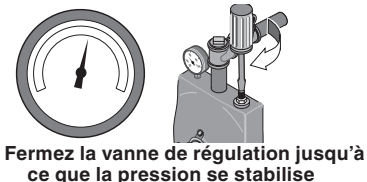
Figure 14 : Régler de la vanne de régulation
